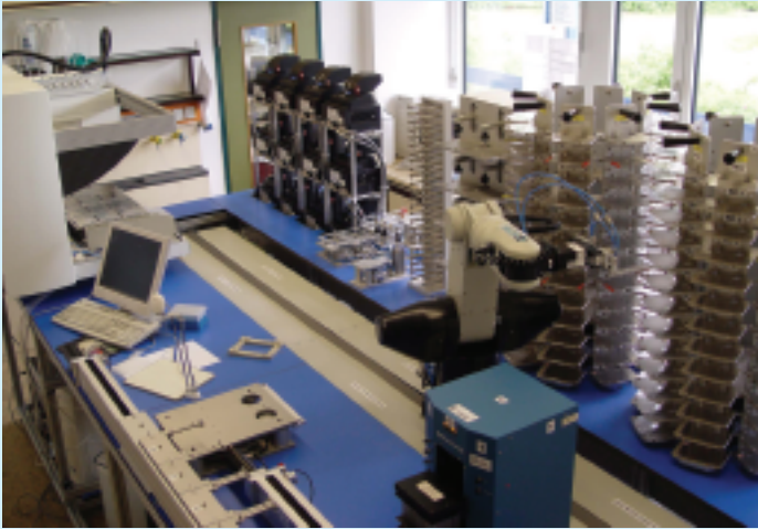
Abb. 2: a) Vollautomatisierte Robotikanlage zur Durchführung der PCR- und Sequenzierungsreaktionen; b) zur Aufreinigung der PCR-Produkte.
