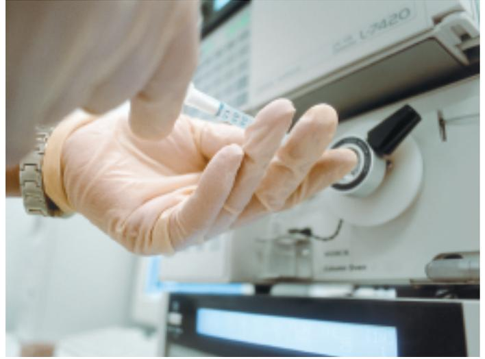
*Injektion eines neuen Wirkstoff-Derivats in eine HPLC-Anlage*
