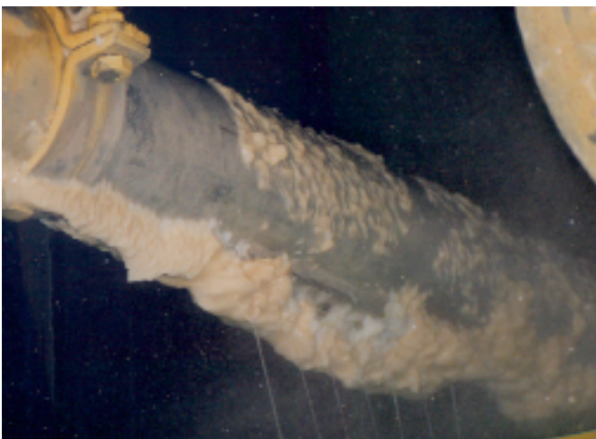
Biofilme: in einer Papierfabrik (links); auf einem Trinkwasserschieber in einem Trinkwasserreservoir (rechts)
