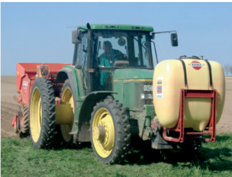
Abb. 1: Kartoffel-Pflanzmaschine mit aufgesatteltem Behälter zur flüssigen Pflanzgutbeizung
