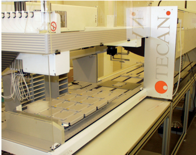
Abb. 1: Roboter zur genetischen Untersuchung von Tausenden von Patientenproben.
