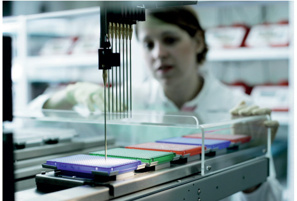
Abb. 1: Automatisches System zur Hochdurchsatz-Genotypisierung. Das Bild zeigt den Blick entlang der Roboterschleife, auf der Mikrotiterplatten zu einem Pipettiergerät bewegt werden. Die Mikrotiterplatten haben viele kleine Vertiefungen, die in Reihen angeordnet sind und in denen sich jeweils die zu untersuchenden DNA-Proben befinden.
