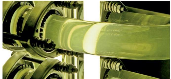
Photobioreaktor für die greenovation – 100 Liter-Volumen im Bau
