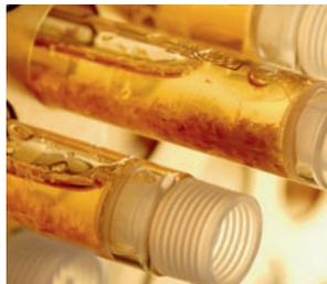
Stroh muss erst aufgeschossen werden, bevor Enzyme es in Zuckereinheiten spalten können (Foto: Fraunhofer IGB).
