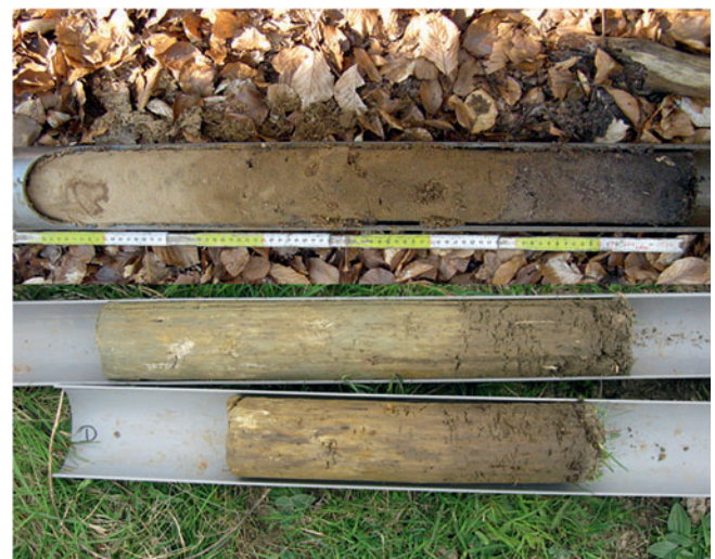
Abb. 1: Bohrkerne von Waldproben (oben) und Grünlandproben (unten). Der Durchmesser der Bohrkerne beträgt 8,3 cm und es wurden Ober- und Unterboden beprobt.
