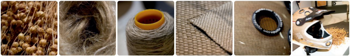
Von der traditionellen Pflanze zum innovativen Produkt. Aus Flachsfasern entsteht ein Motorradhelm. (Fotos: M. Arlt)
